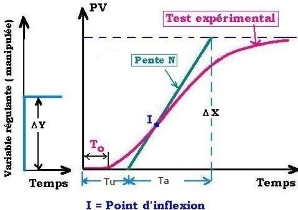
Réponse indicielle du système à régler seul : on mesure les temps  $T_u$  et  $T_g$
