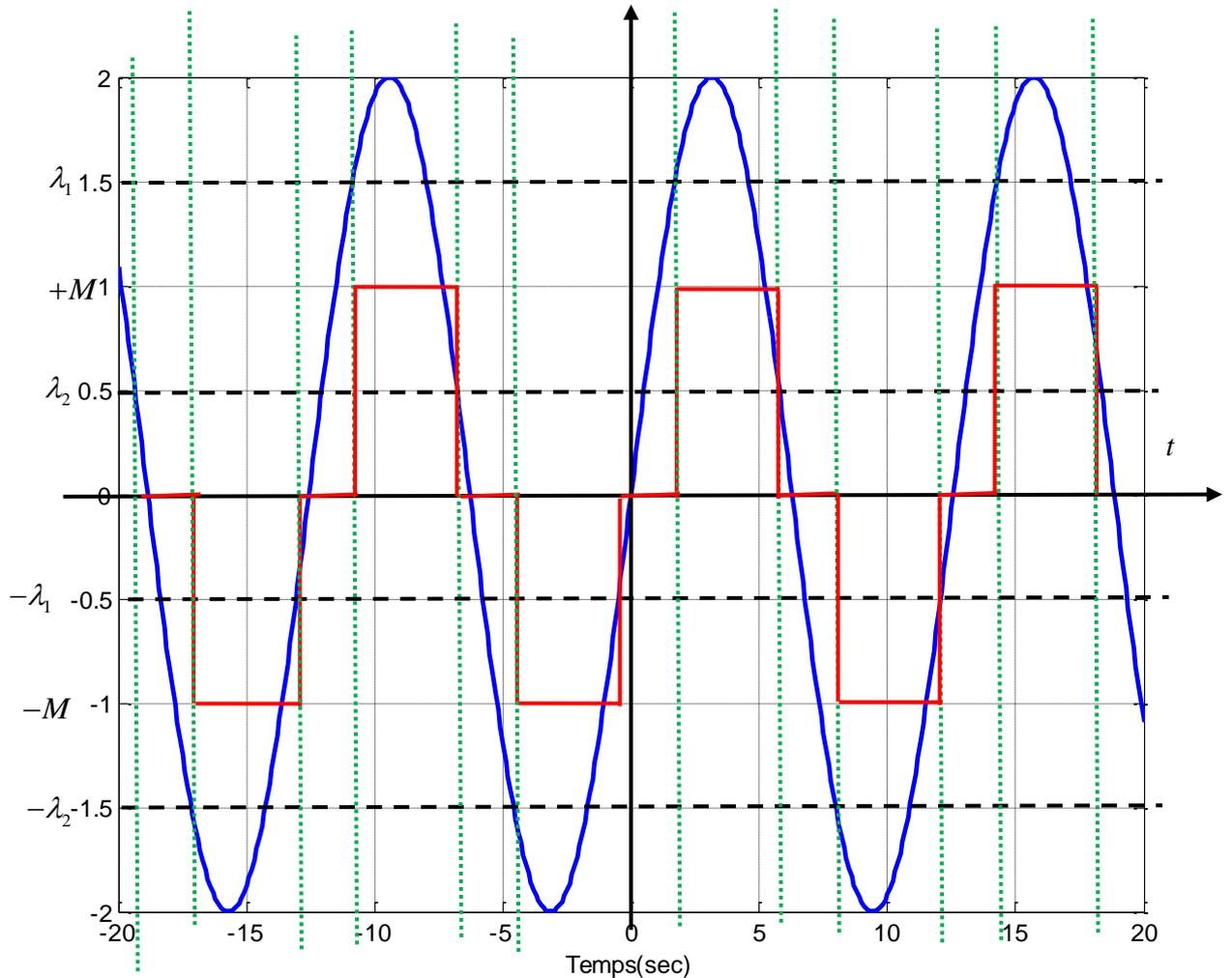
Signal de sortie du régulateur TOR avec seuil et hystérésis
