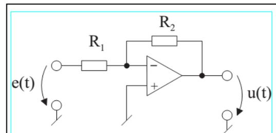
(a) Montage amplificateur inverseur
