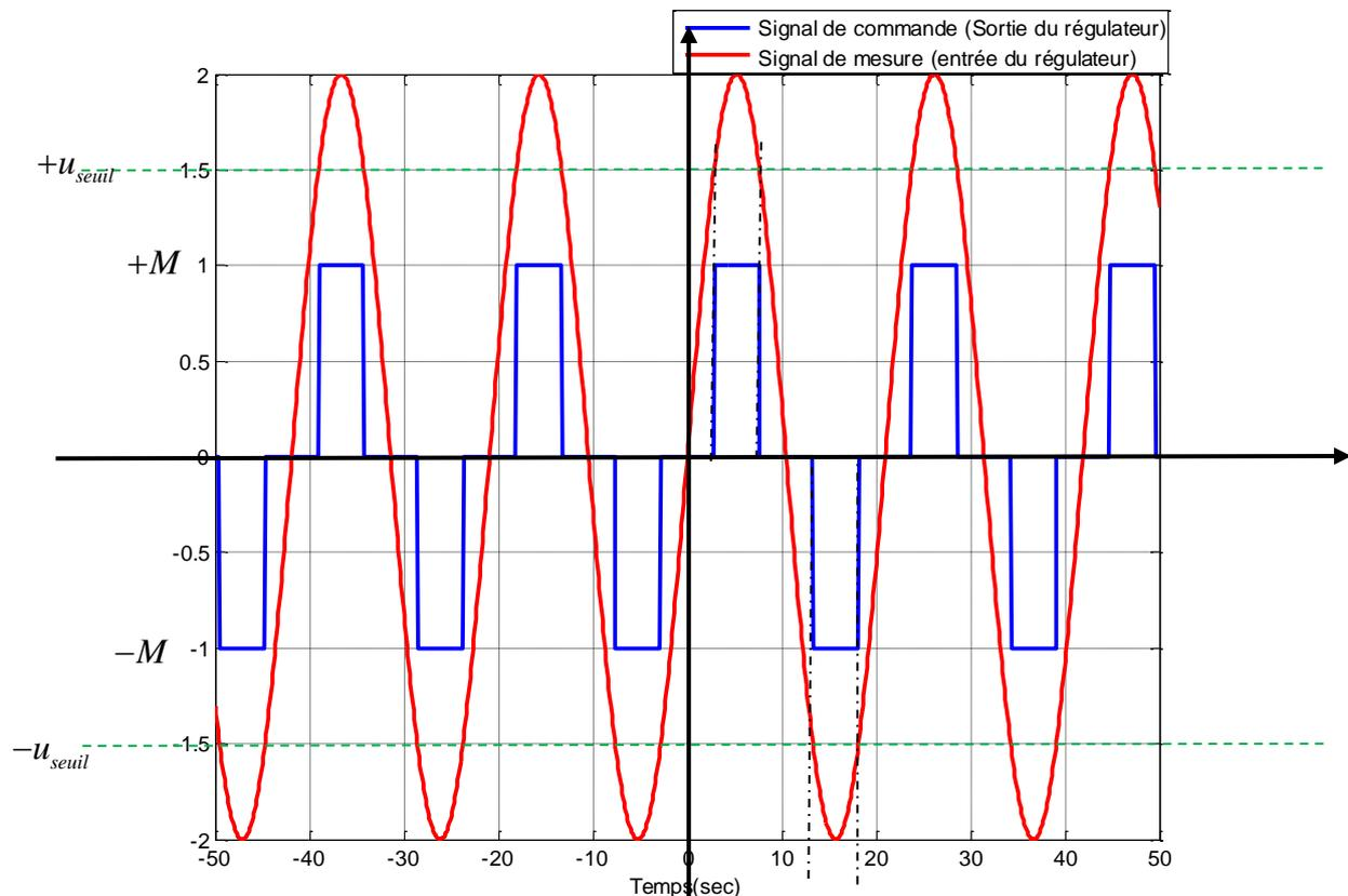
Signal de sortie du régulateur TOR avec seuil ( $u_{seuil} > +M$ )
