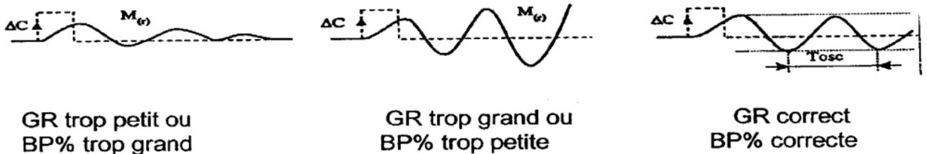
Après avoir relevé le gain critique  $K_c$  et la période d'oscillation  $T_c$  de la réponse. on peut calculer les paramètres du régulateur choisi à l'aide du tableau suivant :
