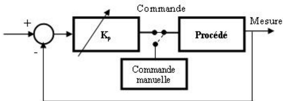
Cette méthode nécessite alors de boucler le système sur un simple régulateur proportionnel dont on augmente le gain jusqu'à amener le système à osciller de manière permanente ; on se trouve ainsi à la limite de stabilité du système.
