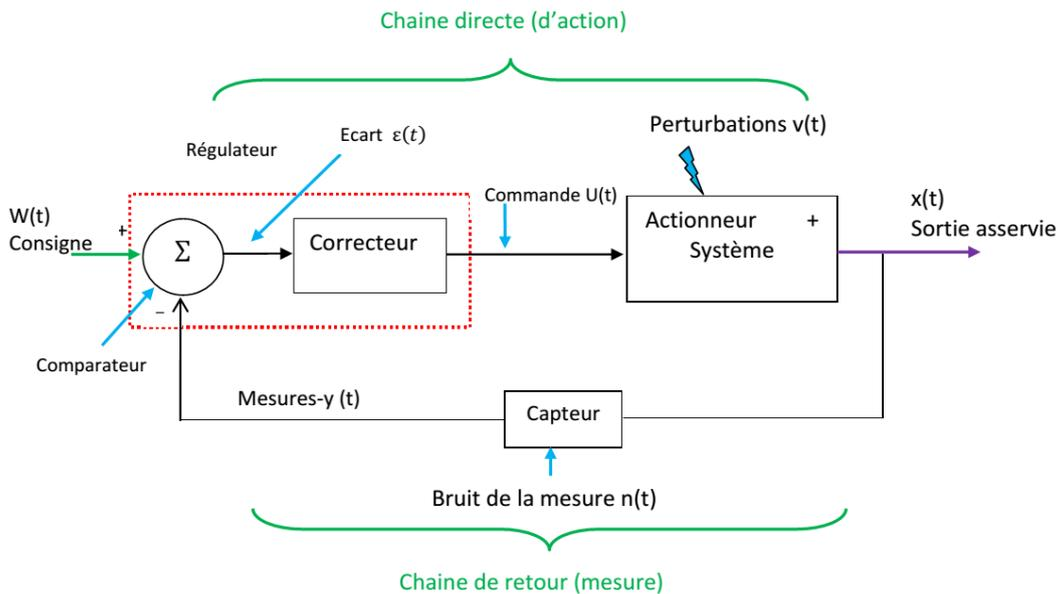
Fonctionnel d'une boucle de régulation
