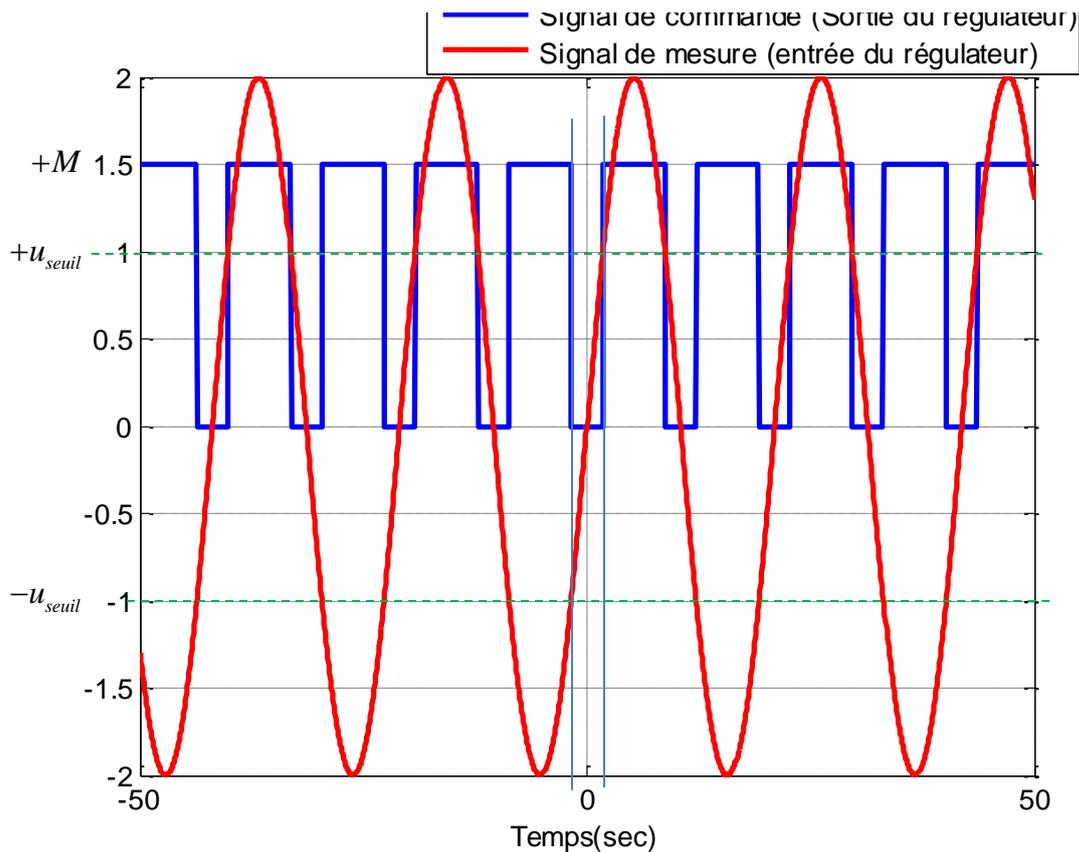
Signal de sortie du régulateur TOR avec seuil (b) ( $u_{seuil} < +M$ )
