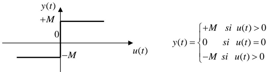
On désire tracer le signal de sortie du régulateur TOR idéal excité par un signal sinusoïdal.
