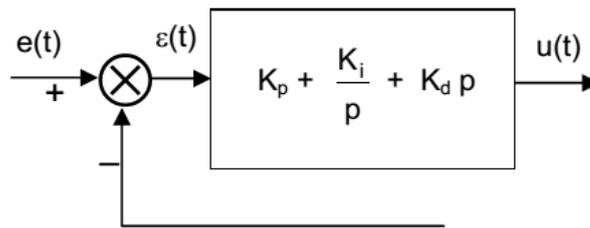
Loi de commande du régulateur PID standard (en parallèle)
