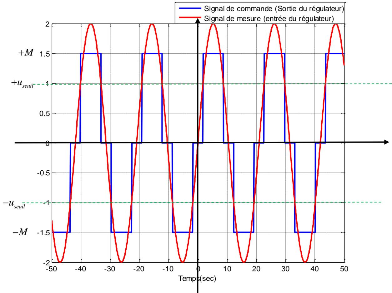
Signal de sortie du régulateur TOR avec seuil ( $u_{seuil} < +M$ )
