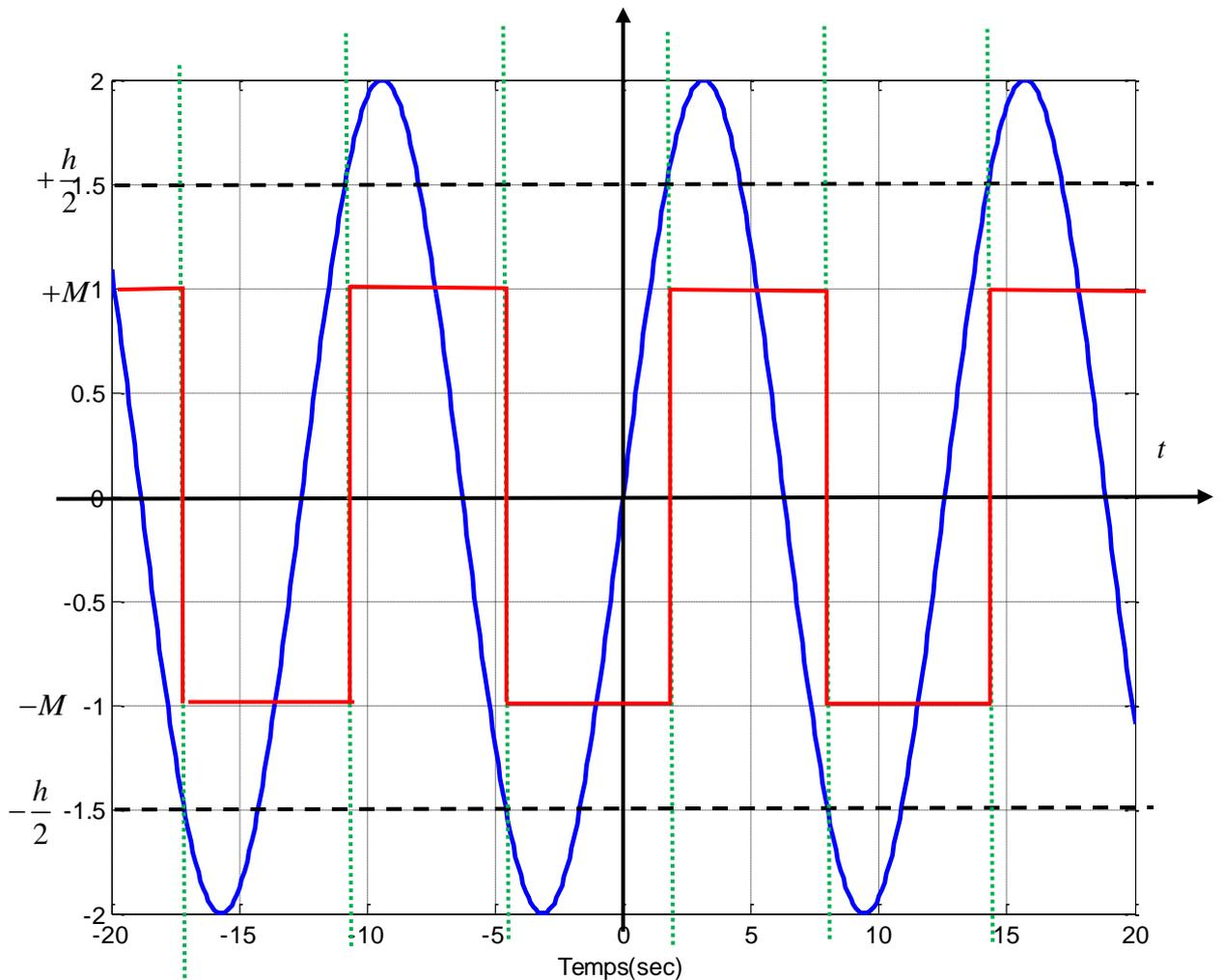
Signal de sortie du régulateur TOR avec hystérésis Fig (a)
