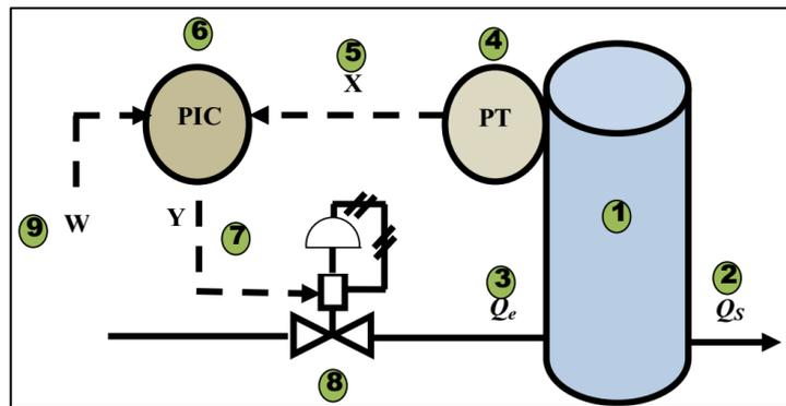
Schéma TI d'une régulation de pression
