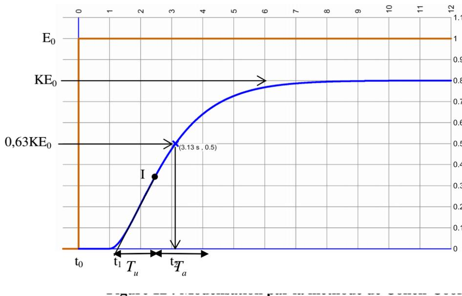
On détermine KE<sub>0</sub>, d'où K. On trace 0,63KE<sub>0</sub>, ce qui nous donne t<sub>2</sub>. On identifie le point d'inflexion I et on trace la tangente à l'origine à la courbe qui passe par I. L'intersection entre cette tangente et l'axe des temps, donne le temps t<sub>1</sub>. t<sub>0</sub> est le temps où l'échelon apparaît. On
