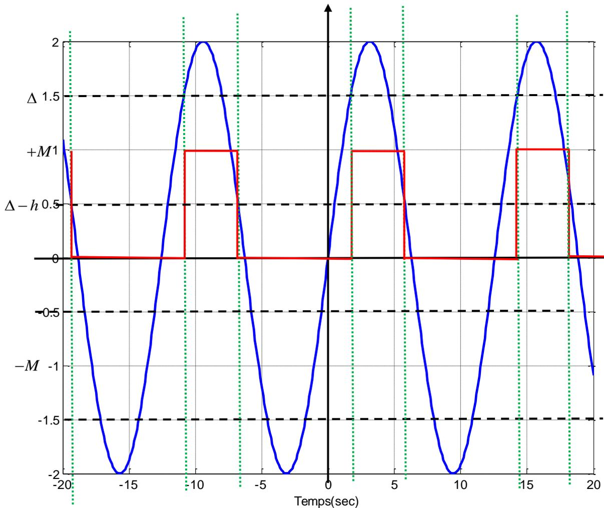
Signal de sortie du régulateur TOR avec hystérésis Fig (b)
