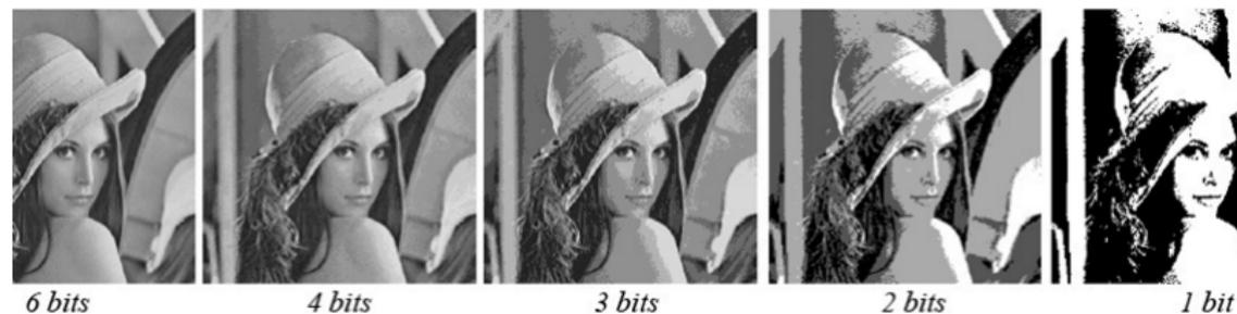
Figure : Résolution tonale : Quantification.
