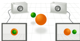
Figure : Deux appareils photo observent la même scène de deux positions différentes
