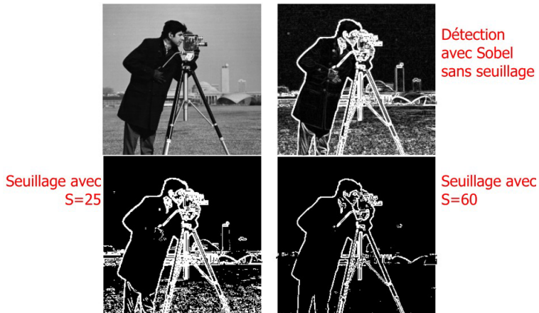
Figure : Détection de contour par le masque de Sobel avec un seuillage.
