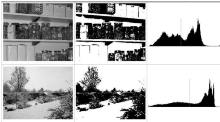
Figure : Exemple de seuillage par méthode d'Otsu
