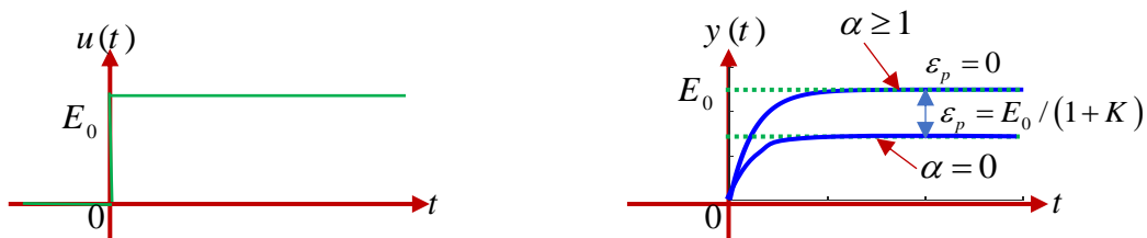
Fig 5.7 : Erreur de position (pour une entrée échelon)
