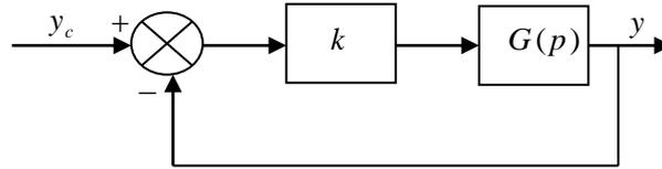
Tracer le diagramme de Bode de la fonction de transfert en BO pour :
