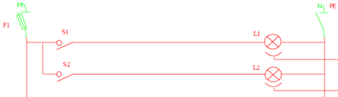
Figure 6.4. Montage double allumage : Schéma développé.
