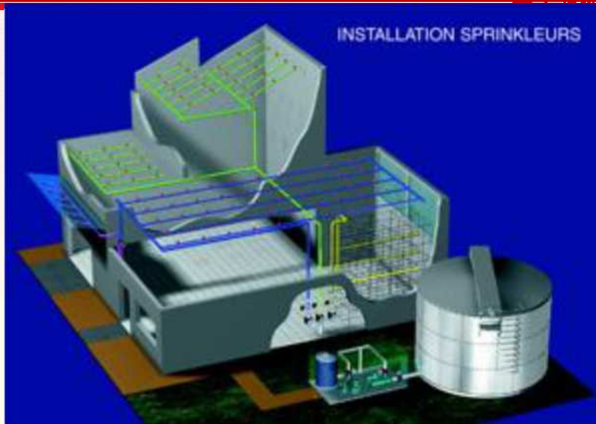
Installation d'extinction Sprinkleurs
