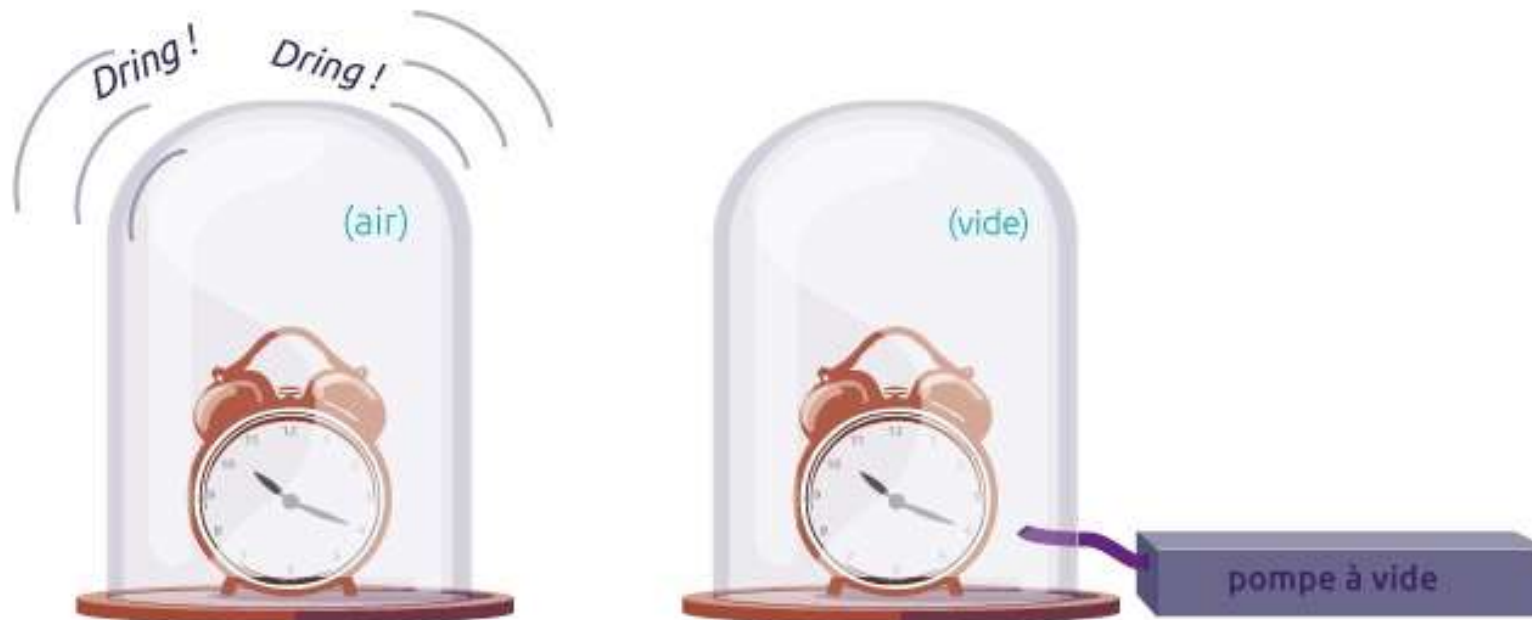
Propagation du son émis par un réveil, dans l'air et dans le vide
