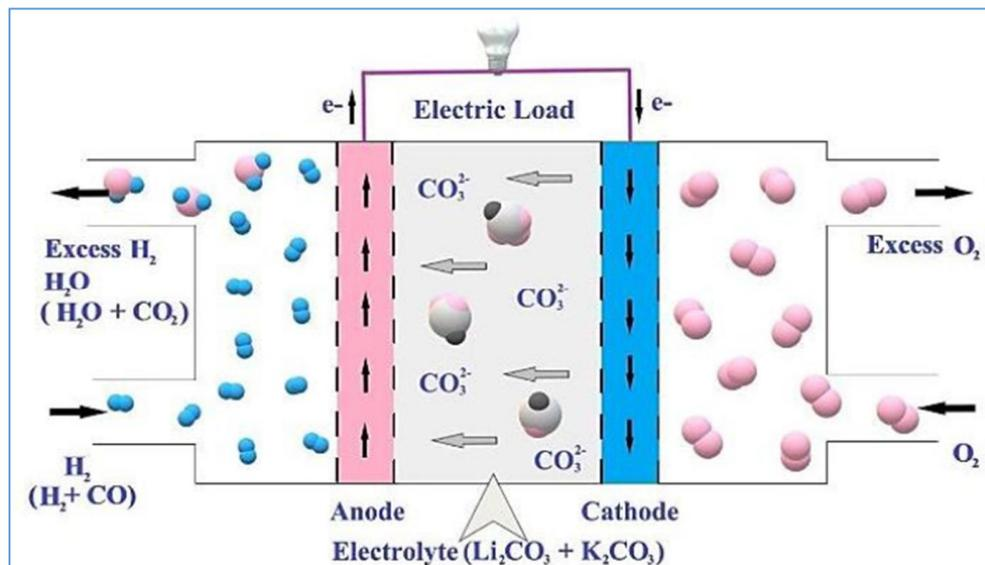
Fig.3.7 : Fonctionnement d'une MCFC[5].
