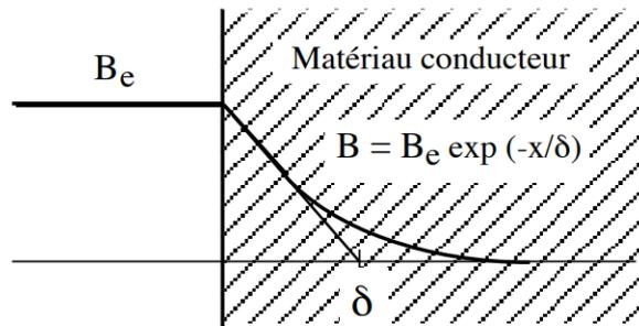
De manière analogue, le courant ne pénètre pas dans un conducteur de forte section (rayon par rapport à  $\delta$ ). Le courant se concentre à la surface. Comme conséquence, la résistance "apparente" augmente et le conducteur est mal utilisé ; une solution est de subdiviser le conducteur.
